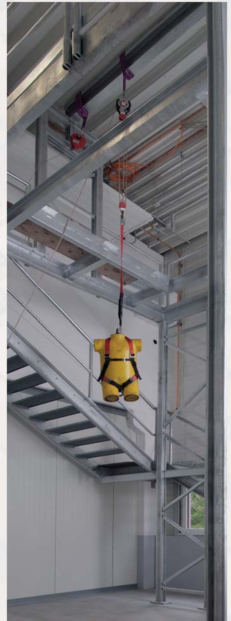
Prüfstand für Absturzsicherung bei MAS
